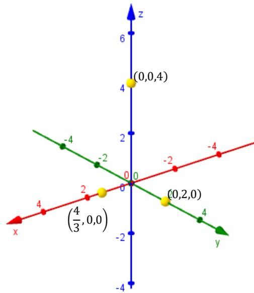
Tres puntos no alineados determinan un único plano que los contiene. Trazamos los segmentos que unen los puntos hallados y obtenemos la representación gráfica de una porción del plano:
