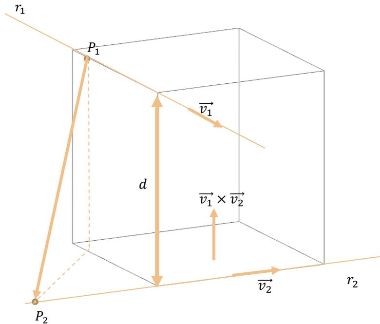
La mínima distancia entre dos rectas alabeadas  $r_1$  y  $r_2$  se obtiene al proyectar el vector  $\overrightarrow{P_1P_2}$  sobre la dirección perpendicular a ambas rectas, dada por  $\vec{v}_1 \times \vec{v}_2$  :
